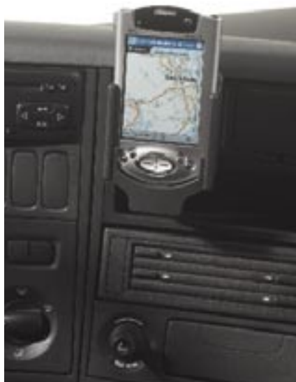
CON UN GPS RECIBIDO Y UN TELÉFONO MÓVIL Y, A INTERVALOS REGULARES, SE ENVÍA UN MENSAJE DE TEXTO A TRAVÉS DE SMS CON LOS DATOS PARA QUE LOS ANALICE EL RECEPTOR GPS.
