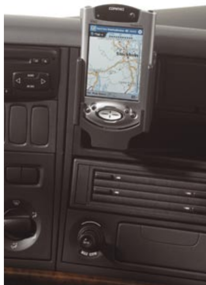
UN RÉCEPTEUR GPS EST PLACÉ À CÔTÉ D'UN TÉLÉPHONE PORTABLE QUI LUI ENVOIE, À INTERVALLES RÉGULIERS, DES MESSAGES SMS CONTENANT LES DONNÉES À ANALYSER.
